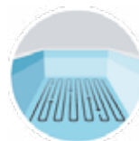
Processus de nettoyage ligne par ligne
