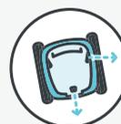
Système de déplacement PowerStream à double entraînement permettant au robot d'accéder à tous les recoins
